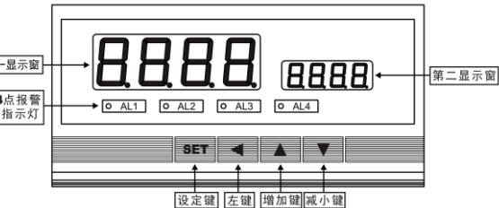
→ 第一显示窗显示 1 通道测量值; 第二显示窗显示 2 通道测量值。
