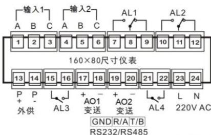
★ 上述端子图仅给出各个选配功能可以选装的位置。具体的报警采用何种形式和组合, 及选配功能的端子示意图, 请以仪表型号和机身上的端子图为准。
